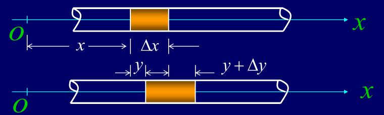
设体元左端的位移为y,右端的位移为  $y + \Delta y$  ,则体元的长度变化量为  $\Delta y$  ,其长应变为  $\frac{\Delta y}{\Delta x}$  或  $\frac{\partial y}{\partial x}$  .
